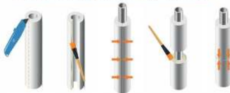
Изоляция смонтированных трубопроводов
